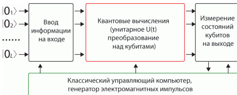
Рис. 25 Схема квантового компьютера
